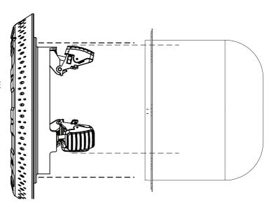
PUSH THE NICHE ADAPTOR INTO THE WALL SO IT SITS FLUSH AND IS FULLY INSERTED INTO THE NICHE
