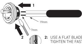
2: USE A FLAT BLADE SCREWDRIVER TO TIGHTEN THE FASTENERS ON EITHER SIDE OF THE SCREW TERMINAL
