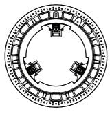
WHEN ALL CAM LOCKS ARE SCREWED TIGHT, THE CAM LOCKS SIT TIGHT AGAINST THE INSIDE OF THE NICHE, AND THE NICHE ADAPTOR IS PULLED FURTHER INTO THE WALL
